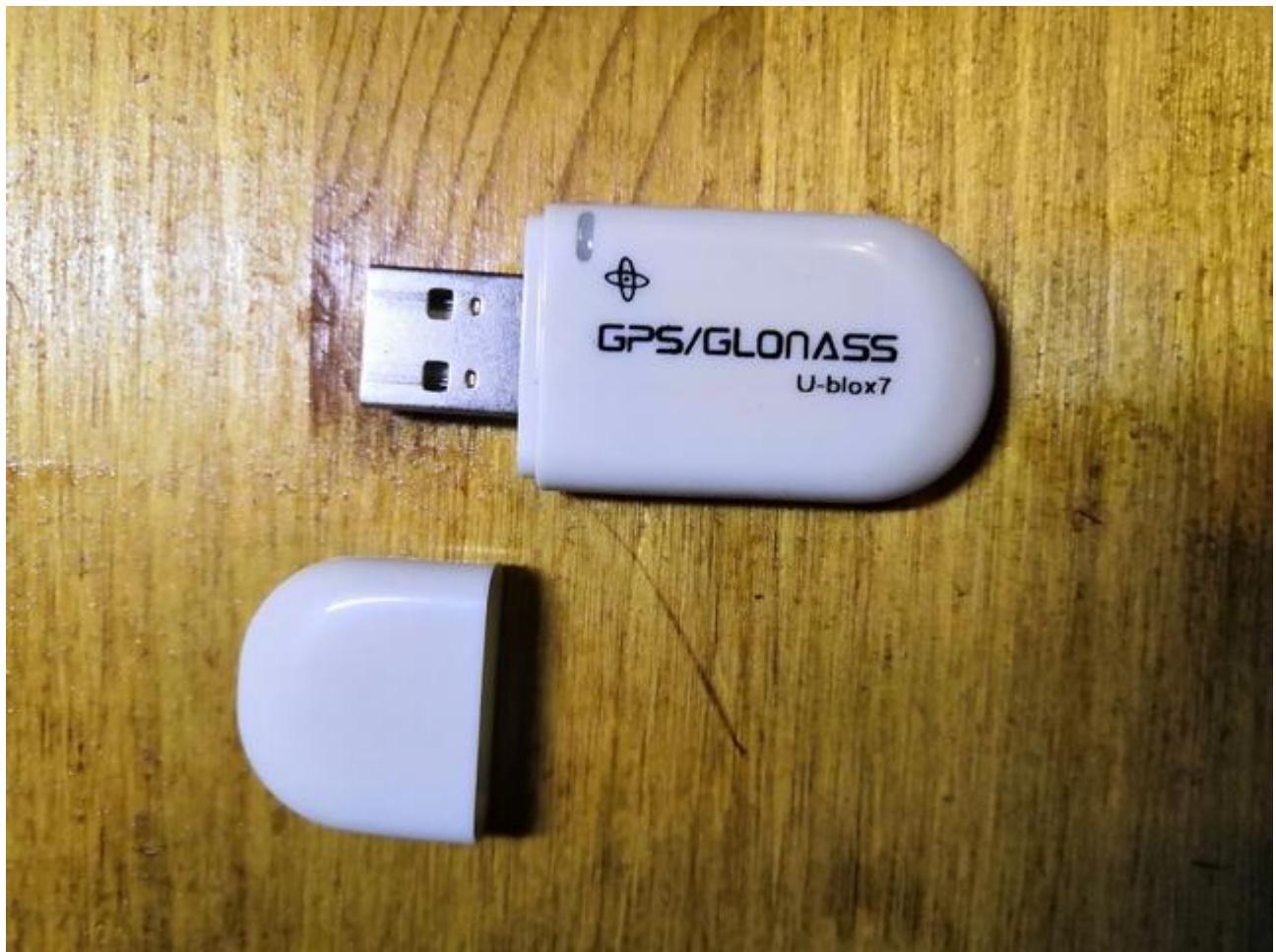
Для установки и настройки GPS приёмника, потребовалось скачать, с сайта производителя чипов u-Blox, программу *i-Center*.
